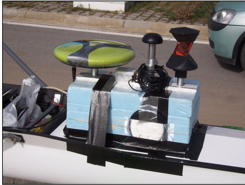
Σχήμα 3.23 Κεραία δέκτη GPS, αδρανειακό σύστημα εντοπισμού και περιβλεπτο πρίσμα τοποθετημένα στο σκάφος Figure 3.23 GPS antenna, inertial guidance system and 360 degrees prism mounted on the boat
