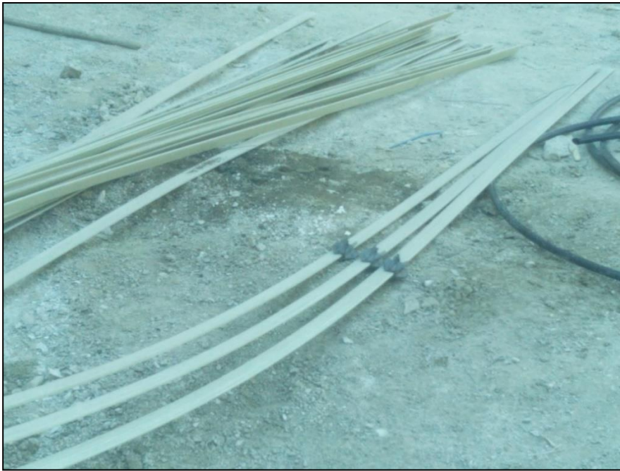
Εικόνα 41 : Αγκύρια fiberglass ορθογωνικής διατομής με κεντραδώρο (Πηγή: Γεωργίου Δ.).
