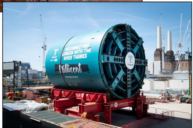
Εικόνα 23 : Δεξιά το EPB TBM Millicent που έσκαψε κάτω από τον Τάμεση τμήμα του κεντρικού αγωγού λημμάτων και πάνω μία από τις θάρδιες που συνέβαλε σε αυτό το ταξίδι. (Πηγή: Γ. Γεωργακόπουλος)
