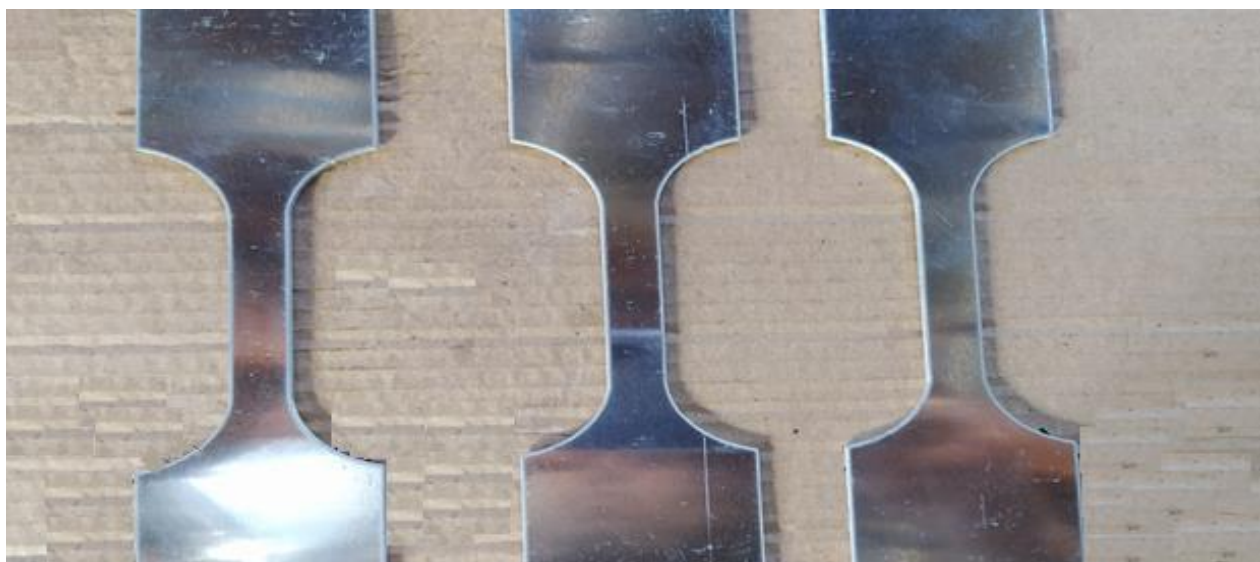
Εικόνα 6.1: Ελάσματα μορφής διπλού T από κράμα αλουμινίου ( Al2024 )
