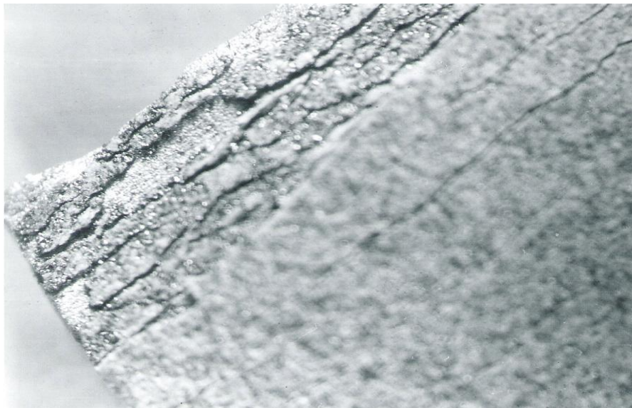
Εικόνα 8.5: Κάτοψη της ρωγματωμένης επιφάνειας Al_2O_3-TiO_2 , μετά τον εφελκυσμό, στην περιοχή της θραύσης [x50]
