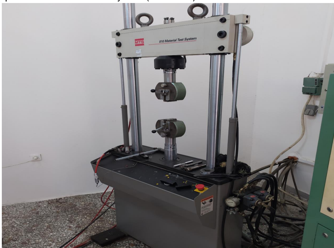
Εικόνα 8.1: Διάταξη δοκιμών εφελκυσμού MTS 810 Material Test System
