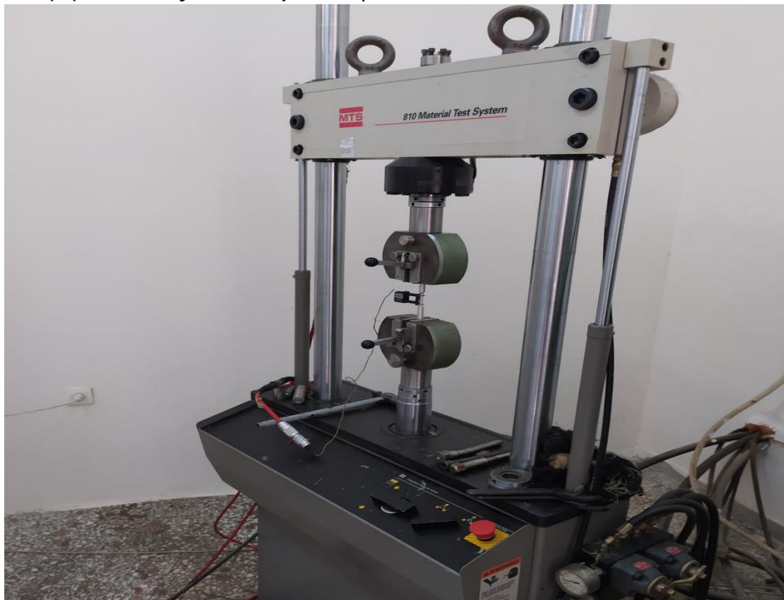
Εικόνα 8.2: Εφελκυσμός κυλινδρικού δοκιμίου το οποίο δεν έχει επικαλυφθεί με την σκόνη METCO 101 NS
