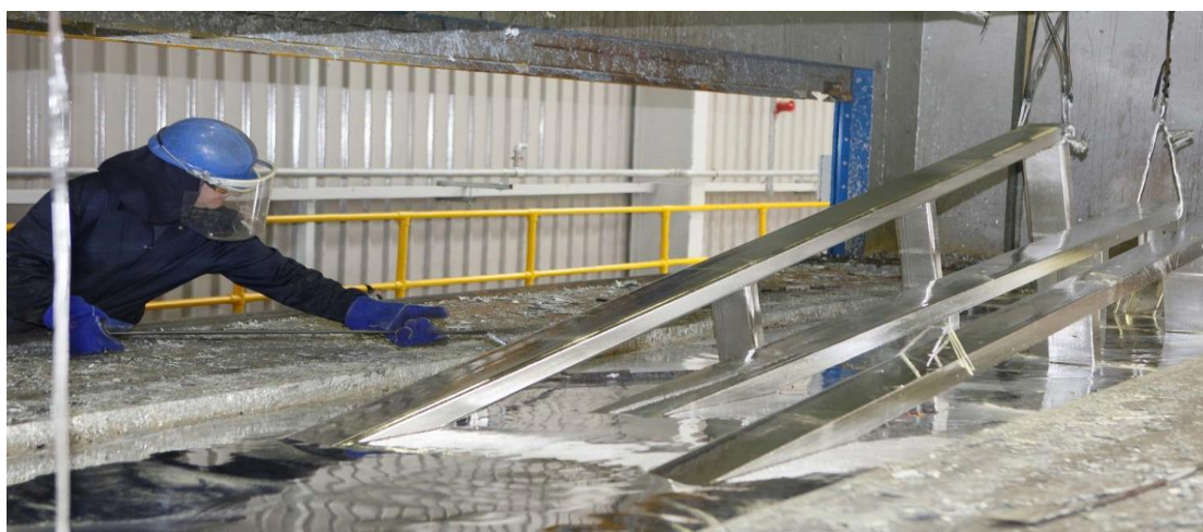
Εικόνα 2.4: Γαλβανισμός μεταλλικού αντικειμένου
