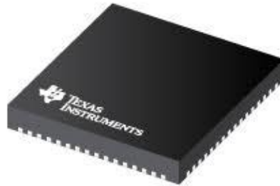
Εικόνα 3-1. Απεικόνιση του μικροελεγκτή CC430F6137, της Texas Instruments.
