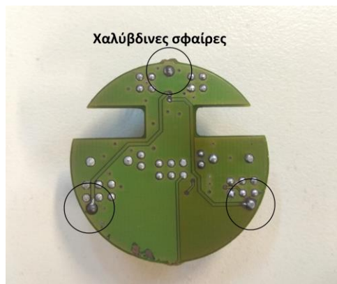
Εικόνα 4-9. Απεικόνιση της κάτω όψης του επιπέδου 3 του μικρορομπότ.
