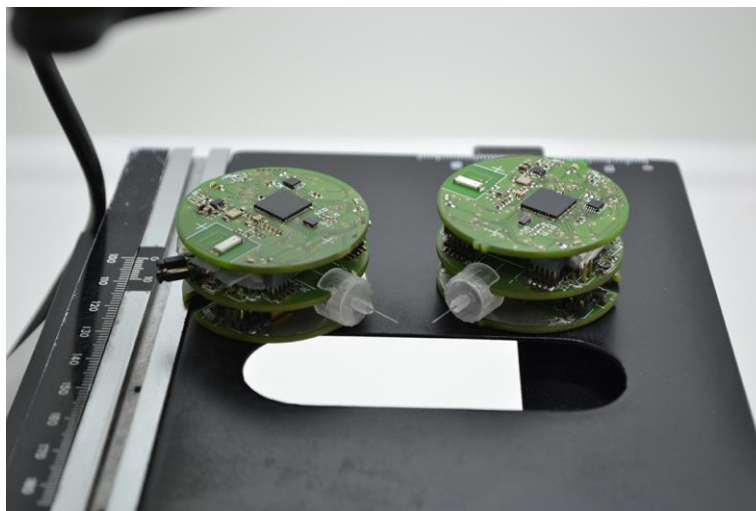
Εικόνα 1-5. Απεικόνιση δύο μικρορομπότ στο χώρο εργασίας τους
