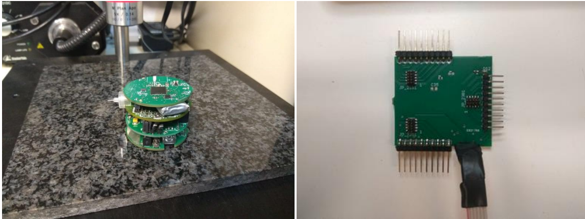
Εικόνα 2-3. 2 η έκδοση του μικρορομπότ α) πλάγια όψη αυτόνομης πλατφόρμας στο χώρο εργασίας του β) επίπεδο 0: προγραμματισμού του ρομπότ [17].
