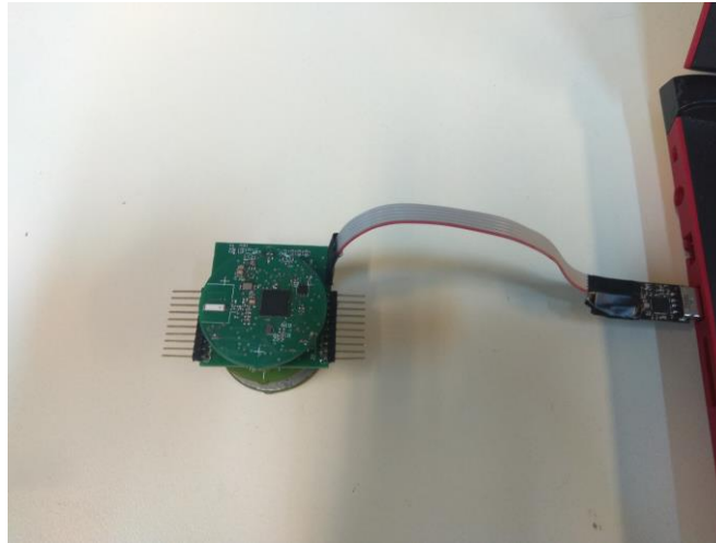
Εικόνα 3-9. Απεικόνιση της διάταξης προγραμματισμού του μικρομπότ.
