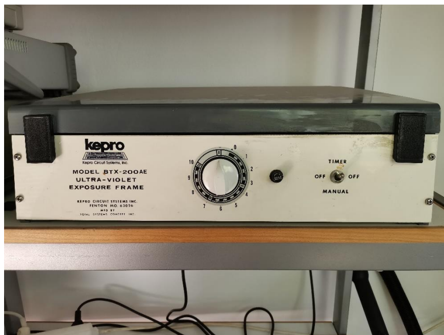
Σχήμα 31: Το φωτοευαίσθητο μηχάνημα που χρησιμοποιήθηκε για την αποτύπωση του σχεδίου στη πλακέτα.
