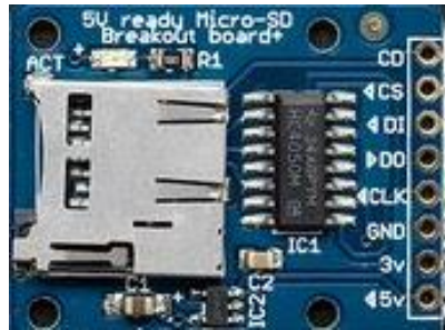
Σχήμα 27: Απεικόνιση του microSD module που χρησιμοποιήθηκε στη διάταξη [29].
