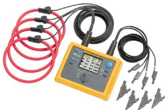
Εικόνα 4.21: Ηλεκτρικός Αναλυτής Ενέργειας Fluke 1735
