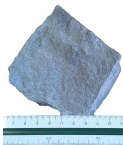
Εικόνα 18. Δείγμα του ιστορικού λίθου δόμησης του γεφυριού. ΕΜΠ (2016).
