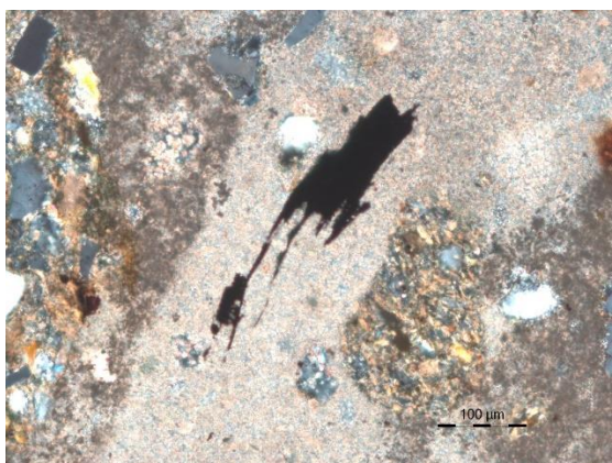
Εικόνα 34. Παράλληλα Nicols x200. Οργανικό υλικό (κάρβουνο) μέσα στη μάζα της κονιάς.
