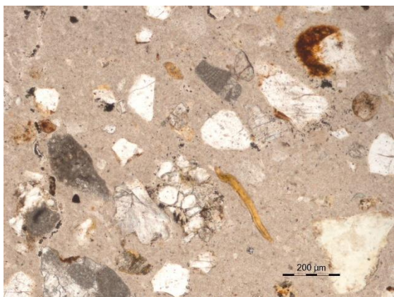
Εικόνα 30. Παράλληλα Nicols x100. Ένα φυλλάριο βιοτίτη δίπλα σε έναν ψαμμίτη, χαλαζίες και ασβεστιτικά αδρανή.
