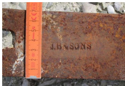
Εικόνα 11. Σφραγίδα που βρέθηκε πάνω σε άρπιζα, με το όνομα της αγγλικής εταιρείας που προμήθευσε τον ιστορικό χάλυβα. ΕΜΠ (2016).
