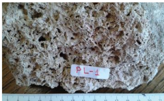
Εικόνα 19. Δείγμα από τον πορόλιθο που βρέθηκε στο εσωτερικό του γεφυριού. ΕΜΠ (2016).
