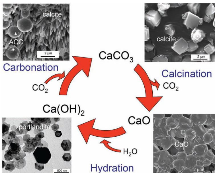
Εικόνα 1. Ο κύκλος όπτησης, ενυδάτωσης και ενανθράκωσης για την παρασκευή αερικής υδρασβέστου..
