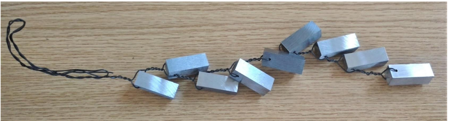
Εικόνα 28: Μορφή ομαδοποιημένων δοκιμίων πριν από τη θερμική κατεργασία.
