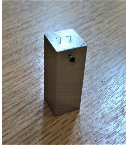
Εικόνα 27: Δοκίμιο εργαλειοχάλυβα H13 πριν από τη θερμική κατεργασία.
