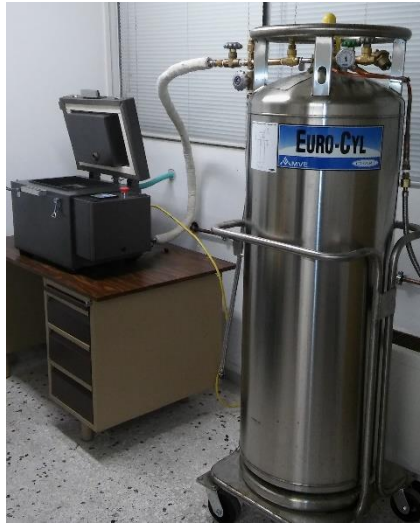
Εικόνα 34: Κρυογενικός θάλαμος και δεξαμενή αποθήκευσης αζώτου.
