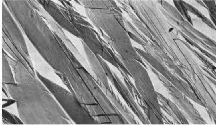
Εικόνα 4: Μαρτενσίτης σε μορφή πλακών.
