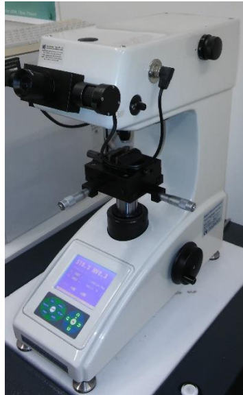
Εικόνα 43: Μηχάνημα λήψης μικροσκληρομετρήσεων.
