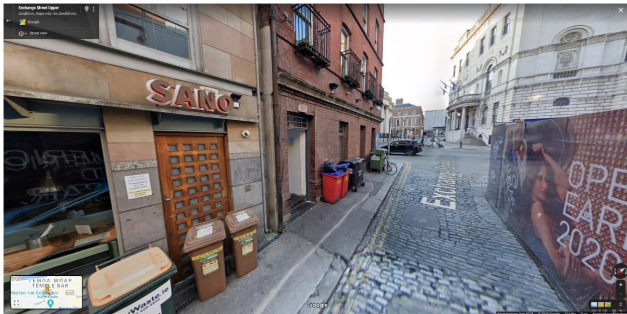
Εικόνα 4.52: Αστικός εξοπλισμός εμποδίζει την μετακίνηση αναπηρικού αμαξιδίου – E3 = 0 (πηγή: Street View)
