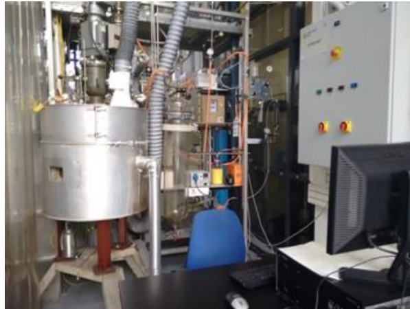
Εικόνα 3: Μονάδα Απόσταξης Κενού HyDis
