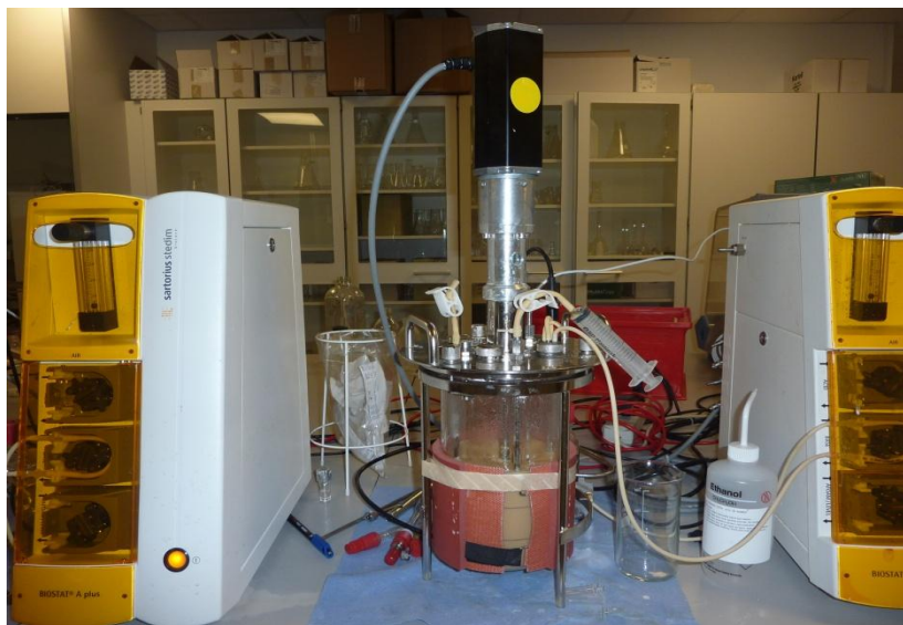
Εικόνα 7. Ο ένας από τους δύο αντιδραστήρες διαλείποντος έργου 3L που χρησιμοποιήθηκαν για τη ζύμωση.
