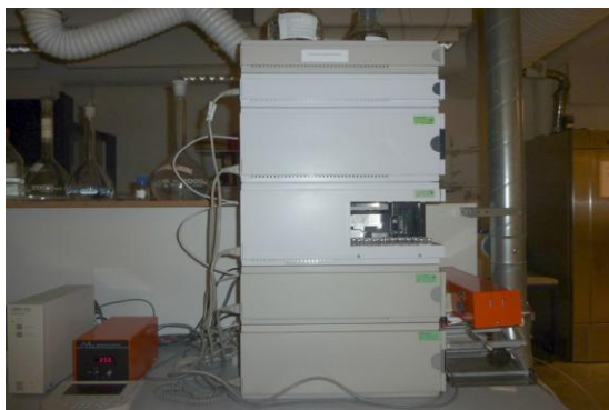
Εικόνα 10. Υγρός χρωματογράφος υψηλής απόδοσης HPLC (Agilent) με στήλη Bio-Rad Aminex HPX - 87H (300 mm x 7.8 mm)
