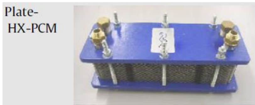
Σχ. 2.31. Εναλλάκτης – πλάκα με ΥΑΦ (Plate HX – PCM) [83]
