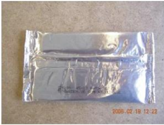
Σχ. 2.21. Μακροενθυλάκωση σε σακουλάκια. Αριστερά, της εταιρείας Climator (εικόνα: Climator), και δεξιά της εταιρείας Dörken (εικόνα: Dörken) [1]
