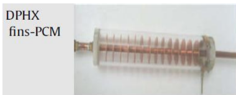
Σχ. 2.28. Εναλλάκτης διπλής σωλήνωσης με πτερύγια και ΥΑΦ (DPHX fins - PCM) [83]
