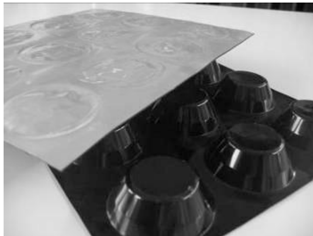
Σχ. 2.20. Μακροενθυλάκωση σε συστοιχία από πλαστικές κοιλότητες όπως αυτές έχουν παραχθεί για ανόργανα ΥΑΦ από τις εταιρείες PCP και Dörken (εικόνα: ZAE Bayern) [1]
