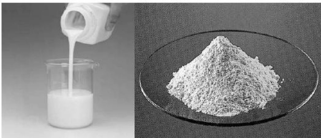
Σχ. 2.24. Μικροενθυλακωμένη παραφίνη που παράγεται από την εταιρεία BASF, στα αριστερά υπό τη μορφή διαλύματος και δεξιά υπό τη μορφή ξηρής σκόνης.(εικόνες: BASF) [1]
