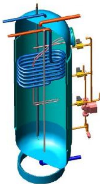
Σχ. 3.12. Δεξαμενή με εναλλάκτη – μανδύα που ρυθμίζεται από τρεις βαλβίδες [59]
