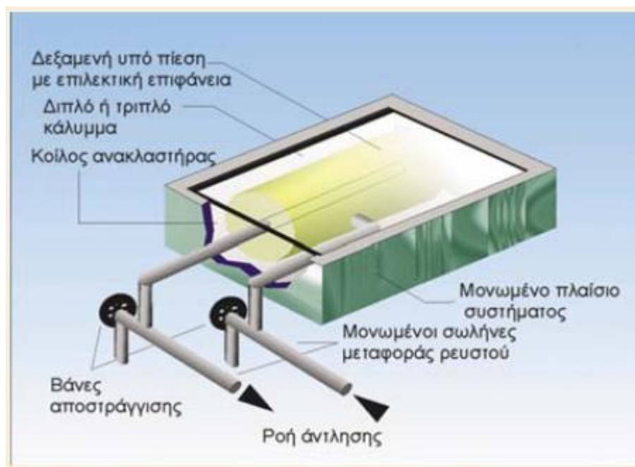
Σχ. 3.2. Τομή συμπαγούς συλλέκτη με ενσωματωμένη δεξαμενή νερού [31]
