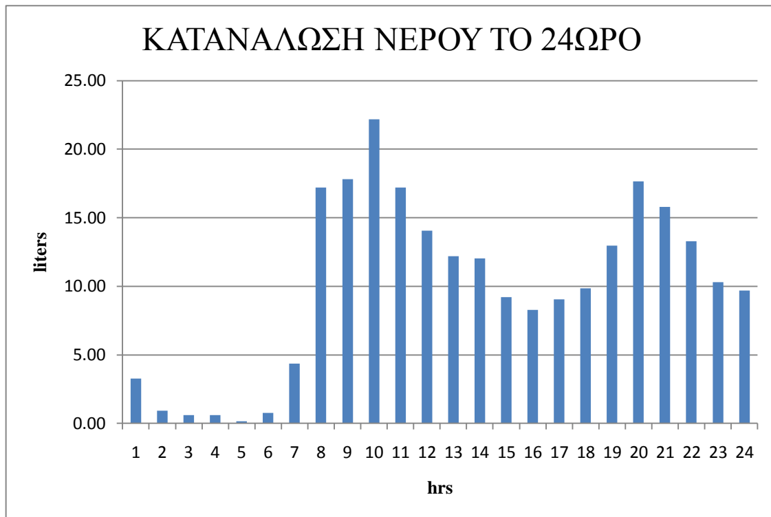
Σχ. 4.6. Ωριαία κατανάλωση θερμού νερού σε οικία κατά τη διάρκεια του 24ώρου [11]
