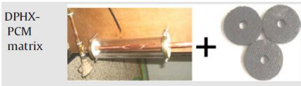
Σχ. 2.29. Εναλλάκτης διπλής σωλήνωσης με ΥΑΦ σε στρώμα από γραφίτη (DPHX- PCM matrix) [83]
