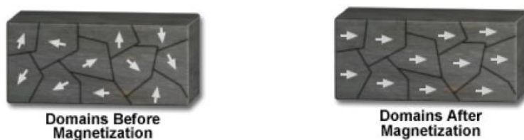
Σχήμα 4.1. Μαγνητικοί τομείς προ (αριστερά) και μετά (δεξιά) μαγνήτισης. Με μαύρο χρώμα φαίνονται τα τοιχώματα που χωρίζουν τους γειτονικούς τομείς [32]
