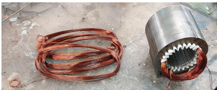
Σχήμα 8.7. Περιέλιξη τυλιγμάτων στάτη ασύγχρονης μηχανής. Αριστερά φαίνονται οι συστάδες των αγωγών, ενώ δεξιά φαίνεται ο στάτης με τοποθετημένες τις μονώσεις και ένα μέρος των τυλιγμάτων στις αύλακες.
