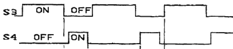
Εικόνα 3.5 Η επιβαλλόμενη καθυστέρηση στο ανοιγόκλειμα του ενός ζεύγους MOSFET, που αποσκοπεί στη μεγιστοποίηση της απόδοσης.
