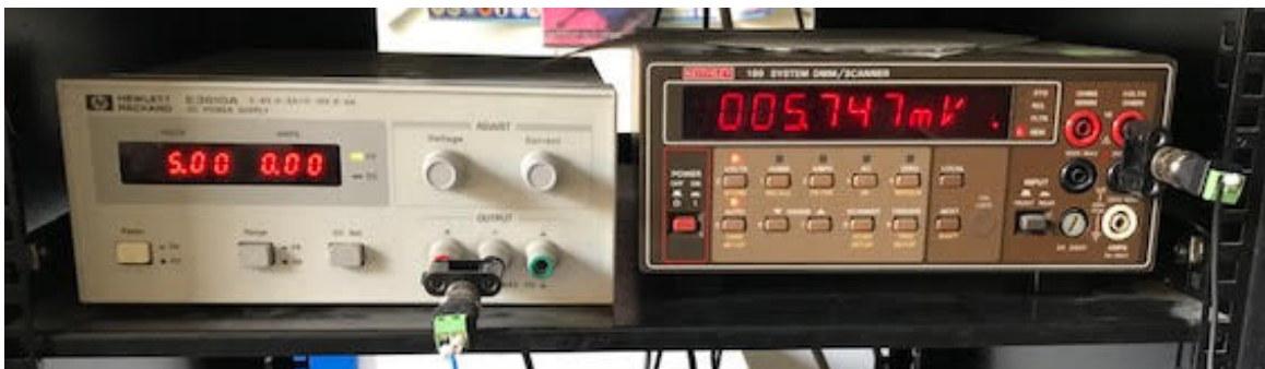
Σχήμα 3.2: Τα πολύμετρα που χρησιμοποιήθηκαν για την τροφοδοσία (αριστερά) και την έξοδο (δεξιά) του αισθητήρα.
