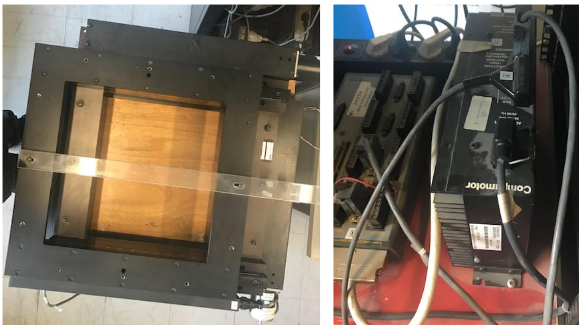
Σχήμα 3.3: Η πλαίσιο 2 αξόνων X-Y-stage της Parker (αριστερά), το οποίο επέτρεψε την ελεγχόμενη κίνηση του αισθητήρα κατά τη λήψη των μετρήσεων, και η γεννήτρια τροφοδοσίας του (δεξιά).
