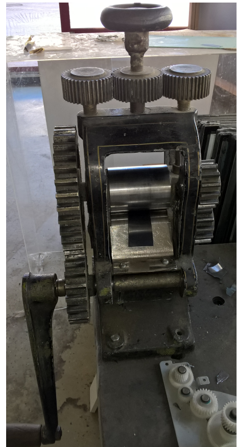
Σχήμα 4.57: Το έλαστρο που χρησιμοποιήθηκε για την ψυχρή διέλαση (cold rolling) των ελασμάτων Fe-Si, το οποίο βρίσκεται στο μηχανουργείο του ΕΚΕΦΕ Δημόκριτος.
