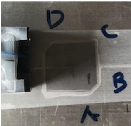
Σχήμα 4.74: Πάνω: Το έλασμα 16 (κράμα Fe-Si), πάχους 0.15 mm. Κάτω: Το έλασμα 16, κατά τη διάρκεια των μετρήσεων με χρήση αισθητήρα GMR AA002-02e.
