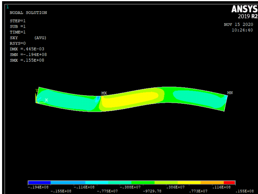
Εικόνα 3. 31 Κατανομή διατμητικών τάσεων \tau_{Xy} στο πάχος σύνθετου για ίνες 45 μοιρών \lambda = 3 , L=80\text{mm} Διακρίνεται η αύξηση των διατμητικών τάσεων από τα ακριανά στο μεσαίο στρώμα
