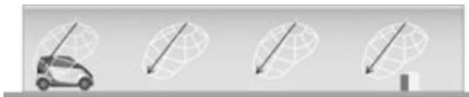
Εικόνα 6: Ασύμμετρο σύστημα φωτισμού counter-beam 13
