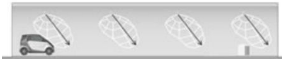
Εικόνα 7: Ασύμμετρο σύστημα φωτισμού pro-beam 14
