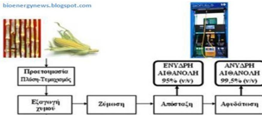
Σχήμα 2.9. Διάγραμμα ροής παραγωγής βιοαιθανόλης.
