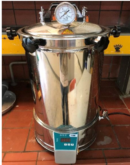
Σχήμα 5.5 Κλίβανος αποστείρωσης ISOLAB Laborgerate GmbH Autoclave.
