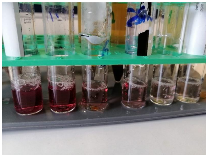
Σχήμα 5.7. Προσδιορισμός ελεύθερης γλυκόζης με τη μέθοδο GOD/PAP.
