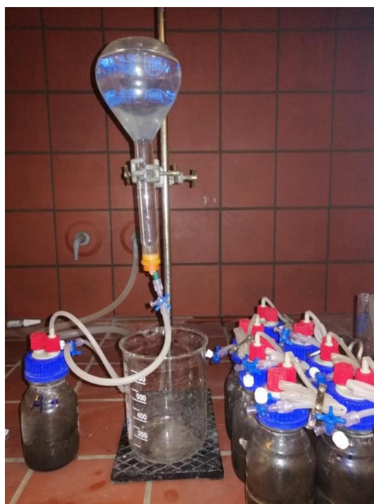
Σχήμα 5.11. Πειραματική διάταξη μέτρησης δυναμικού παραγωγής βιοαερίου
