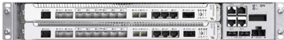
Εικόνα 3: BaseBand Unit (BBU) [7]
