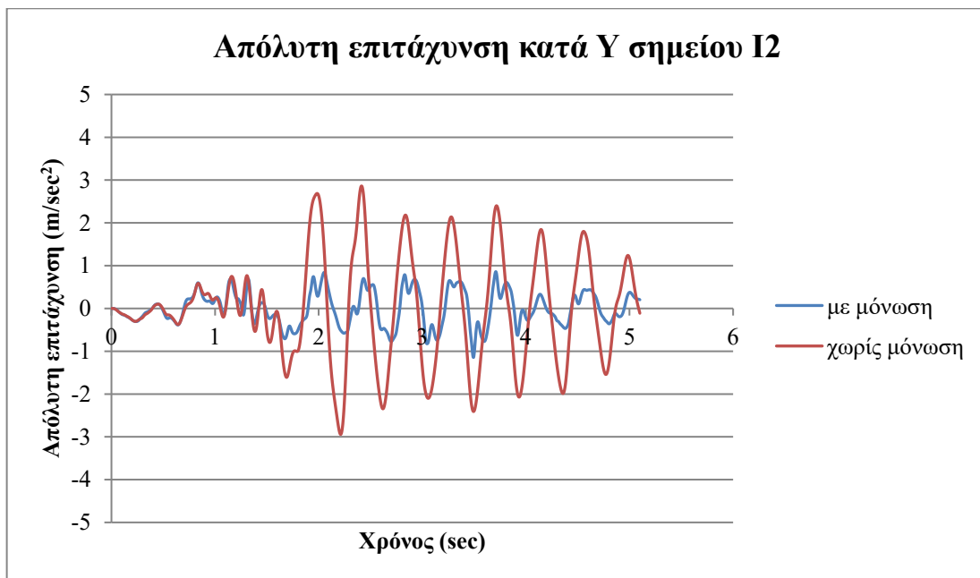
Εικόνα 6.10: Απόλυτες επιταχύνσεις κατά Y, σημείων I1 και I2 της οροφής του ισογείου, για το υφιστάμενο και το σεισμικά μονωμένο κτίριο.
