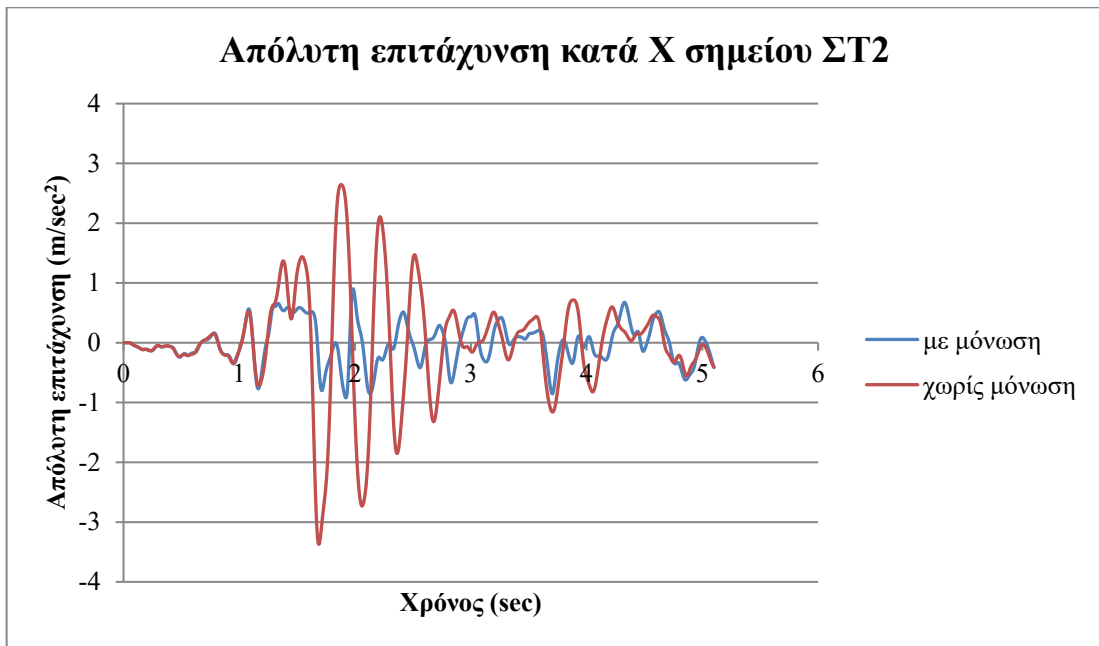
Εικόνα 6.8: Απόλυτες επιταχύνσεις κατά X, σημείων ΣΤ1 και ΣΤ2 της στέγης του κτιρίου, για το υφιστάμενο και το σεισμικά μονωμένο κτίριο.
