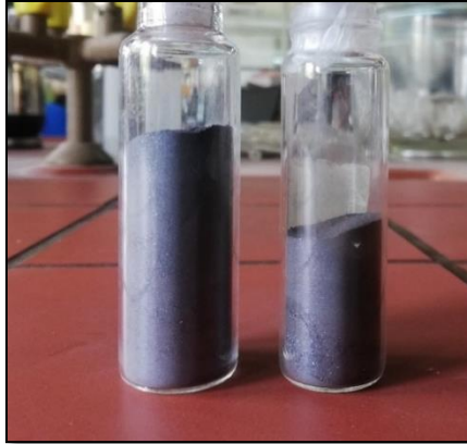
Σχήμα 23: Τελική μορφή σκόνης πυριτίου με προσμίξεις
