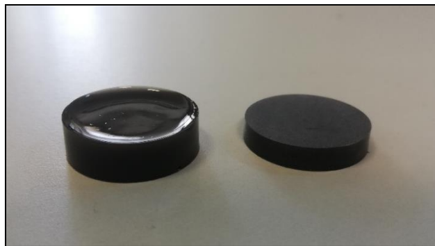
Σχήμα 35: Αρχική και τελική μορφή δοκιμίων διηλεκτρικών μετρήσεων
