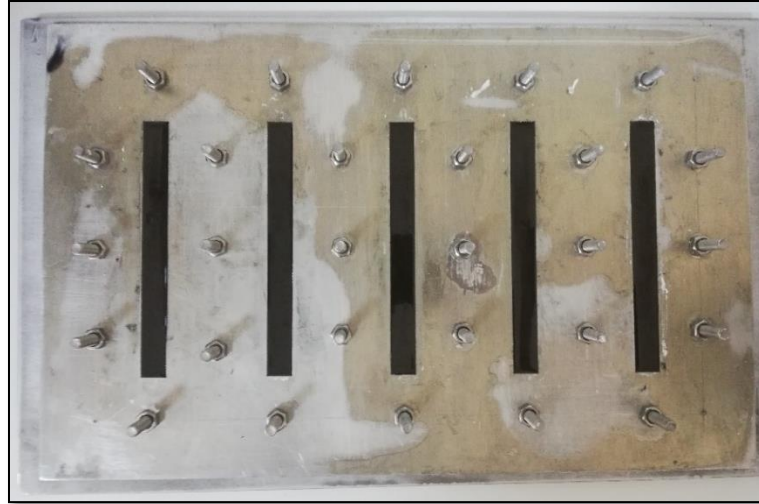
Σχήμα 36: Φωτογραφία καλούπιου για μηχανικές μετρήσεις με Araldite 7.5%
