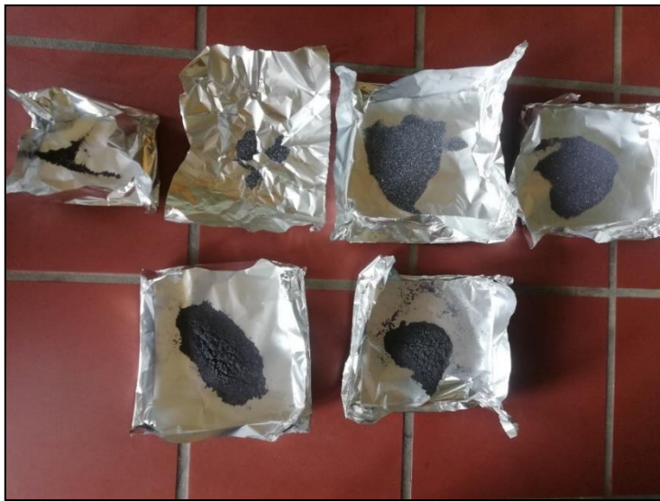
Σχήμα 25: Επιμέρους ποσοστά μάζας πυριτίου με φθίνουσα διάμετρο
