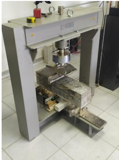
Εικόνα 21. Συσκευή για την διενέργεια της δοκιμής της κάμψης τριών σημείων πρισμάτων
