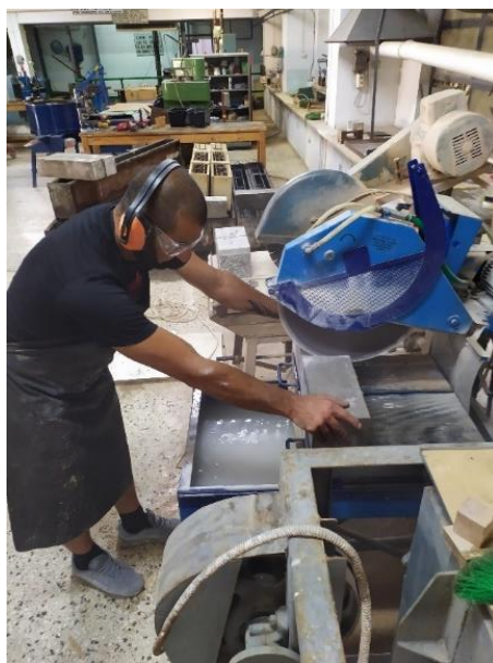
Εικόνα 20. Διαμόρφωση της εγκοπής στο μέσον του πρισματικού δοκιμίου για την διενέργεια της δοκιμής της κάμψης τριών σημείων και την μέτρηση του CMOD
