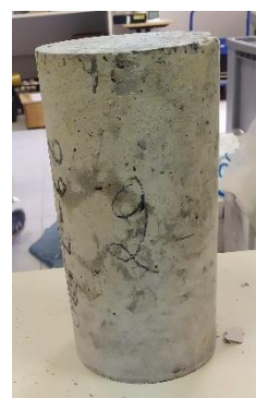
Εικόνα 38. Αστοχία δοκιμίων σε θλίψη μη ινοπλισμένου και ινοπλισμένου ελαφροσκυροδέματος
