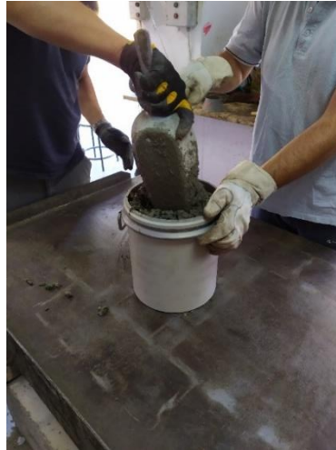
Εικόνα 17. Δοχείο μέτρησης της μάζας και πυκνότητας του νωπού σκυροδέματος
