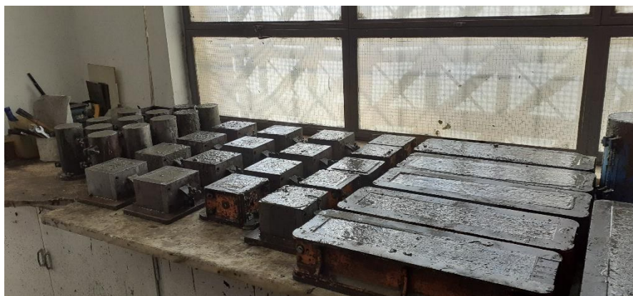
Εικόνα 8.12. Δοκίμια άοπλου σκυροδέματος λίγο μετά τη χύτευση.
