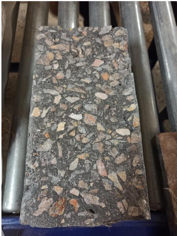
Εικόνα 8.20. Τομή δοκιμίου ύστερα από την αστοχία του στην δοκιμή έμμεσου εφελκυσμού.
