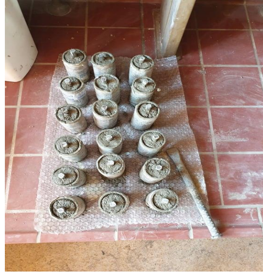
Εικόνα 8.3. Δοκίμια τσιμεντοκονιάματος με νανοσωλήνες άνθρακα αμέσως μετά την χύτευση στα καλούπια.
