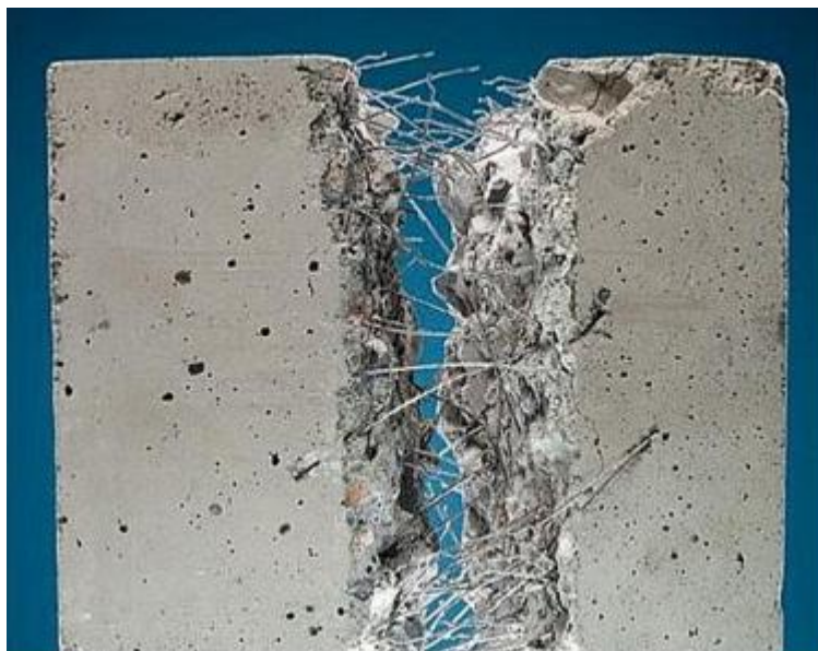
Εικόνα 6.1. Μακροσκοπική συμπεριφορά άοπλου σκυροδέματος ενισχυμένου με μεταλλικές ίνες.
