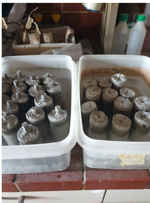
Εικόνα 8.5. Δοκίμια εμβαπτισμένα σε διαβρωτικό περιβάλλον.
