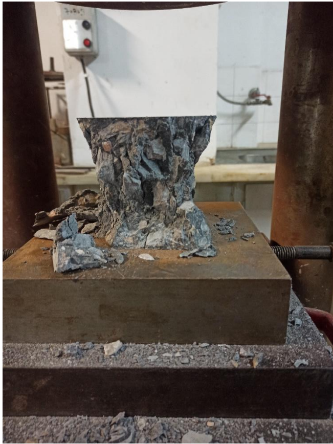
Εικόνα 8.17. Δοκίμια σε αστοχία αμέσως μετά την δοκιμή μονοαξονικής θλίψης
