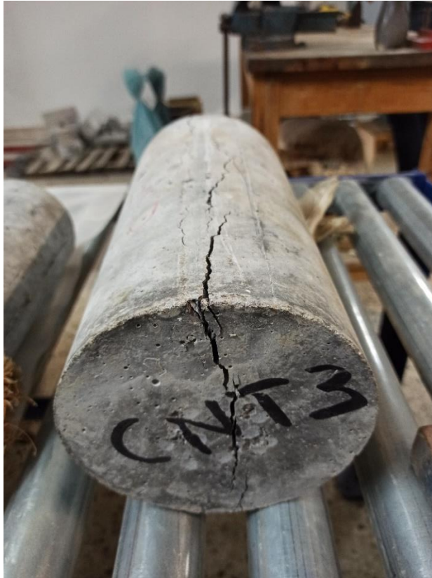
Εικόνες 8.19.a,b. Δοκίμια σκυροδέματος με CNTs σε αστοχία ύστερα από την δοκιμή εφελκυσμού (Brazilian test).
