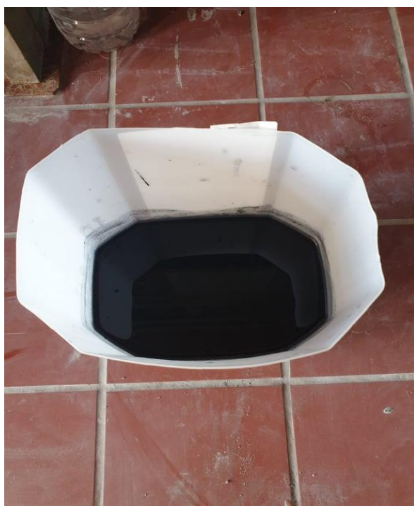
Εικόνα 8.2. Νανοςωλήνες άνθρακα διαλυμένοι σε νερό λίγο πριν την ανάμειξη για την κατασκευή ενισχυμένου τσιμεντοκονιάματος.
