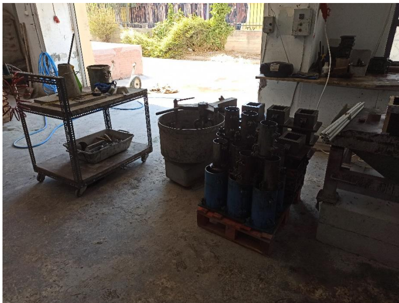
Εικόνα 8.8. Αναμεικτήρας, χαλύβδινα καλούπια και τράπεζα δόνησης λίγο πριν την σκυροδέτηση .
