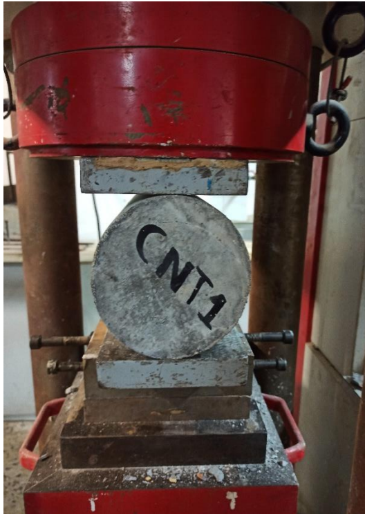
Εικόνα 8.18. Δοκίμιο σκυροδέματος με CNTs υποβαλλόμενο σε δοκιμή έμμεσου εφελκυσμού (Brazilian test)
