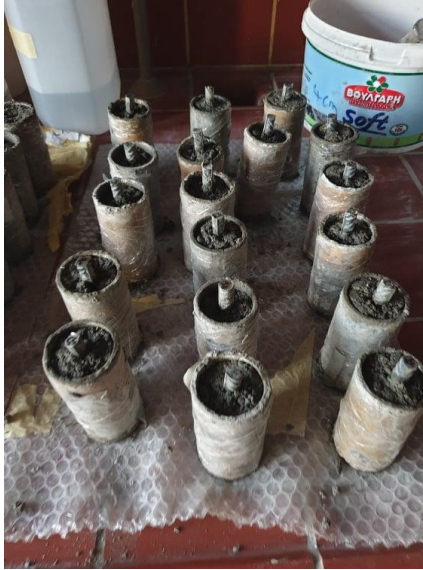
Εικόνα 8.3. Δοκίμια τσιμεντοκονιάματος με νανοσωλήνες άνθρακα αμέσως μετά την χύτευση στα καλούπια.
