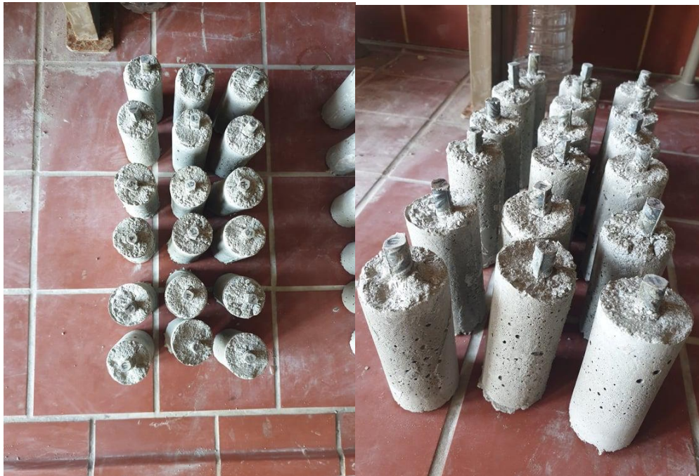
Εικόνα 8.4. Δοκίμια αναφοράς τσιμεντοκονιαμάτων (REF) μετά την αφαίρεσή τους από το καλούπι.
