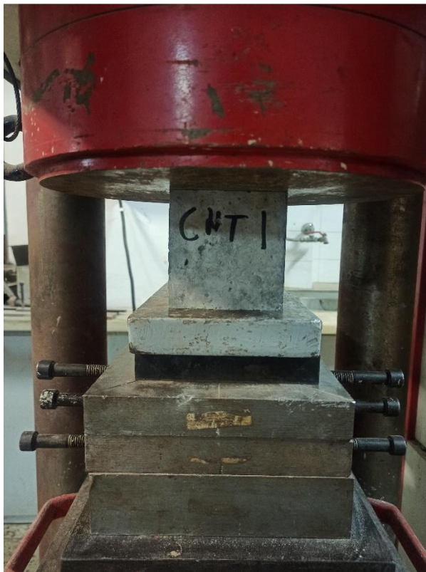
Εικόνα 8.16. Κυβικό δοκίμιο με νανωσωλήνες άνθρακα (CNT) υποβαλλόμενο σε δοκιμή μονοαξονικής θλίψης.
