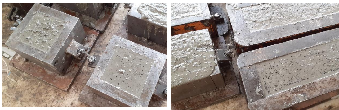
Εικόνα 8.13. Σκυρόδεμα σε καλούπια αμέσως μετά τα στάδια της χύτευσης και δόνησης.
