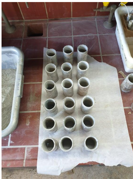
Εικόνα 8.1. Καλούπια από πολυμερές μετά από καθαρισμό για κατασκευή δοκιμίων τσιμεντοκονιάματος.
