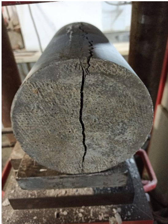
Εικόνα 8.18. Δοκίμιο σκυροδέματος με CNTs υποβαλλόμενο σε δοκιμή έμμεσου εφελκυσμού (Brazilian test)
