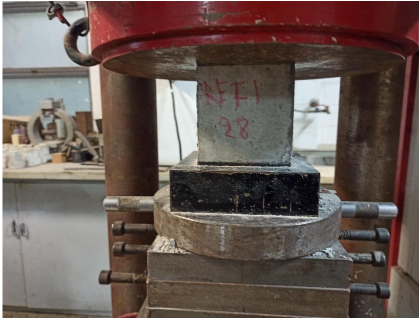
Εικόνα 8.15. Κυβικό δοκίμιο αναφοράς (REF) υποβαλλόμενο σε δοκιμή μονοαξονικής θλίψης.
