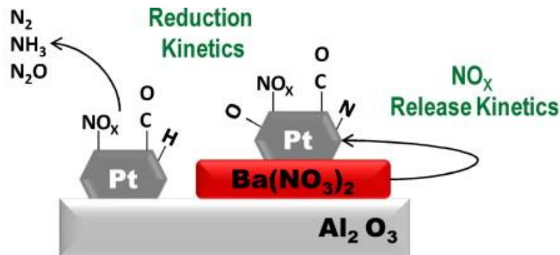
Σχήμα 2.8: Εικονική αναπαράσταση των χημικών αντιδράσεων σε έναν καταλύτη LNT [7]
