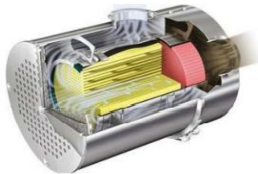
Σχήμα 2.2: Τομή παγίδας αιθάλης (κίτρινο χρώμα) κατάντι του οξειδωτικού καταλύτη (κόκκινο χρώμα) μοντέρνου κινητήρα Diesel [2]
