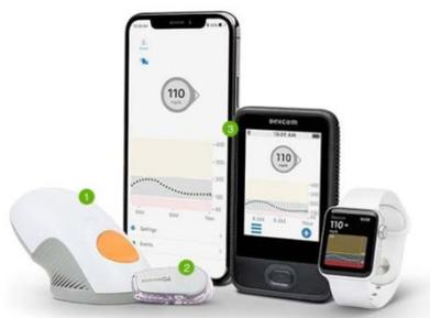
**Σχήμα 2.5:** Η συσκευή DexCom G6. 1:Συσκευή τοποθέτησης, 2:Αισθητήρας, 3:Οθόνες εμφάνισης αποτελεσμάτων [32].
