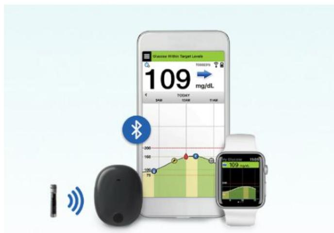
**Σχήμα 2.7:** Η συσκευή Eversense. Από αριστερά προς τα δεξιά φαίνονται ο εμφυτεύσιμος αισθητήρας, ο εξωτερικός πομπός και η συσκευή(κινητό ή smartwatch) με το απαραίτητη εφαρμογή [37].
