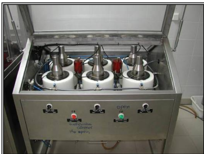
ΣΧΗΜΑ 6.2 Λεπτομερής άποψη της μονάδας με τα 6 κελιά ΥΠ των 42 ml το καθένα, που χρησιμοποιείται για κινητικές μελέτες.
