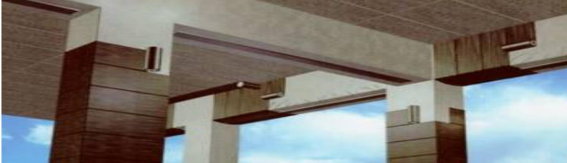
Εικόνα 7.11: Ενίσχυση υποστυλωμάτων-δοκών με μανδύες σύνθετων υλικών
