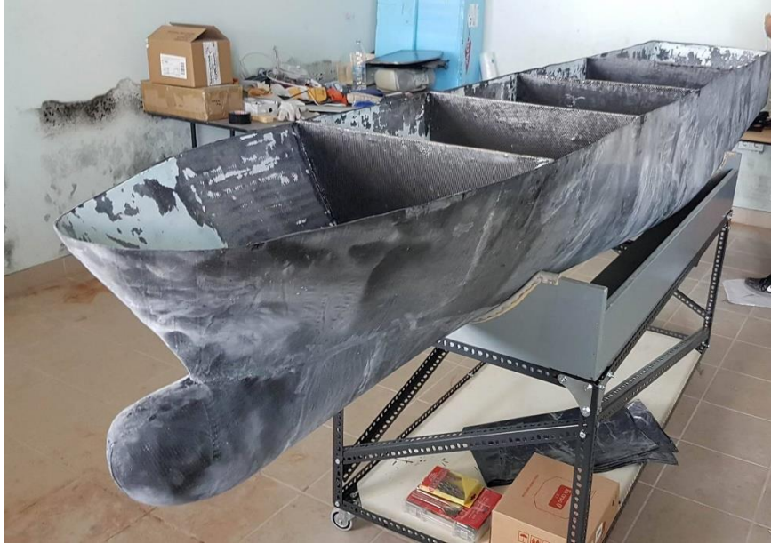
Εικόνα 39-Αποτέλεσμα διαδικασίας ντυσίματος
