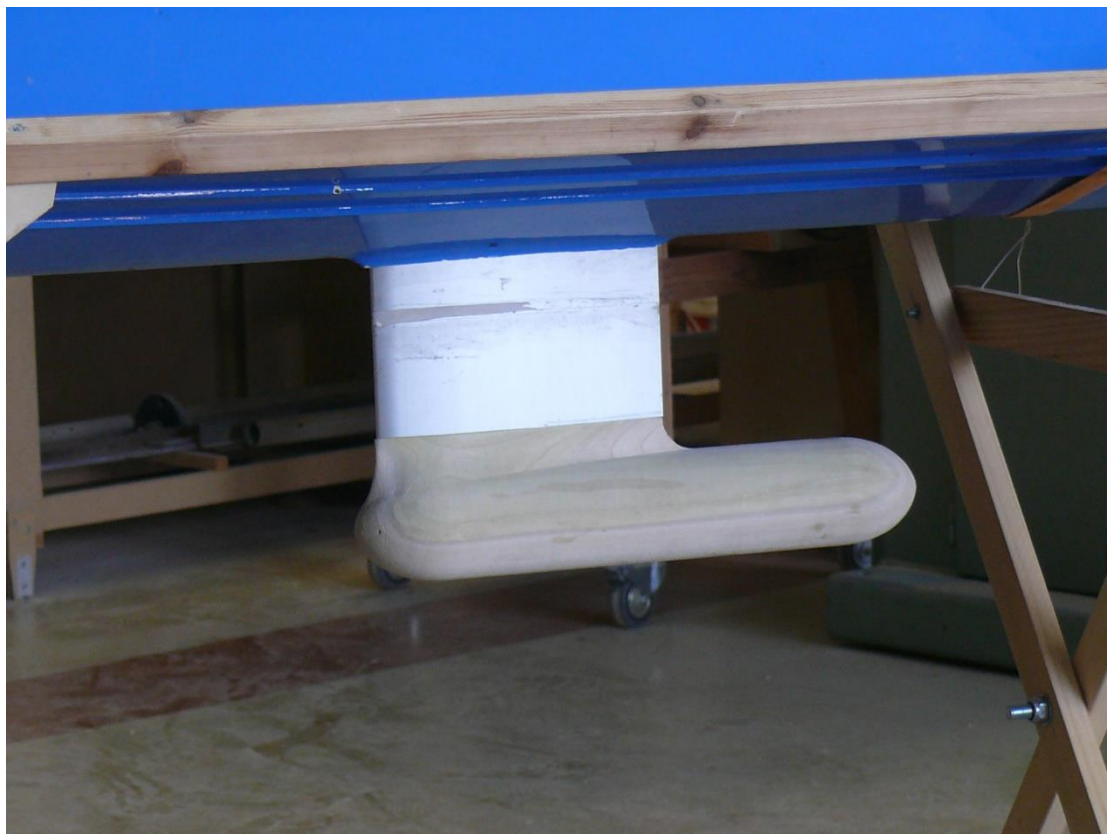
Εικόνα 25- Ένωση rod με σκάφος
