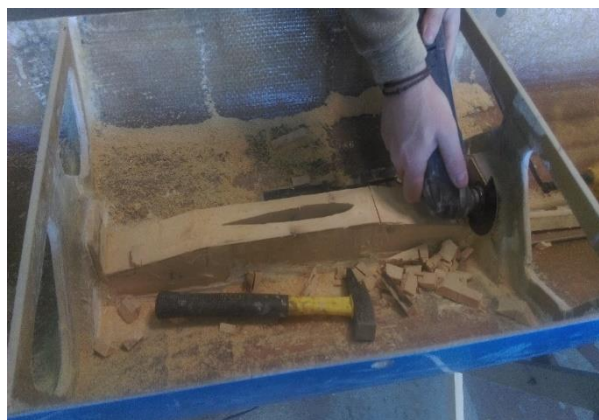
Εικόνα 19- Διαδικασία κοπής βάσης κινητήρα
