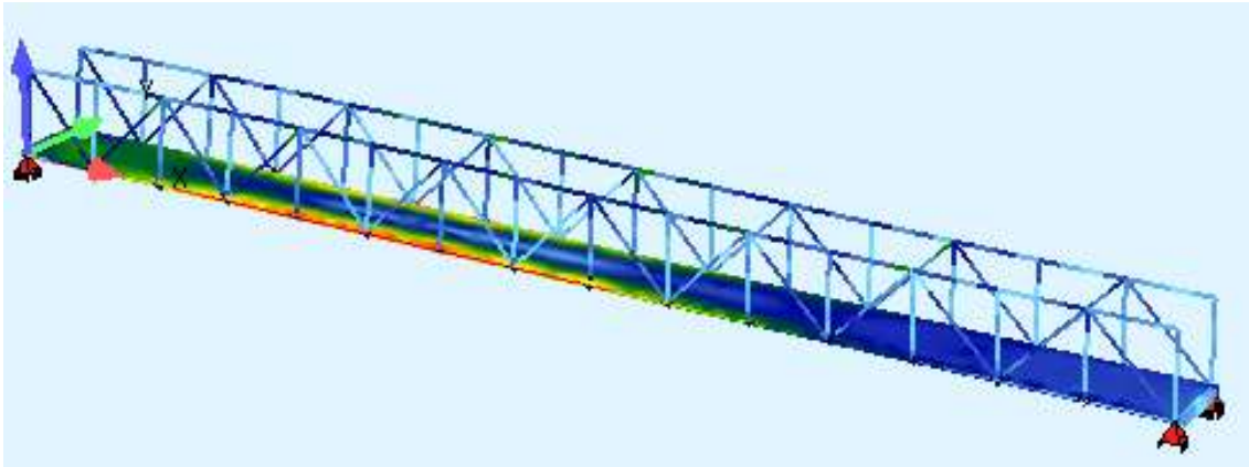
Εικόνα 4.5: 3 η ιδιομορφή με f=0.014\text{Hz} και συμμετρική οριζόντια μετακίνηση κύριας δοκού κατά Y.
