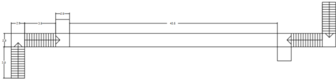
Σχήμα 2.1: Κάτοψη σύμμικτης πεζογέφυρας.
