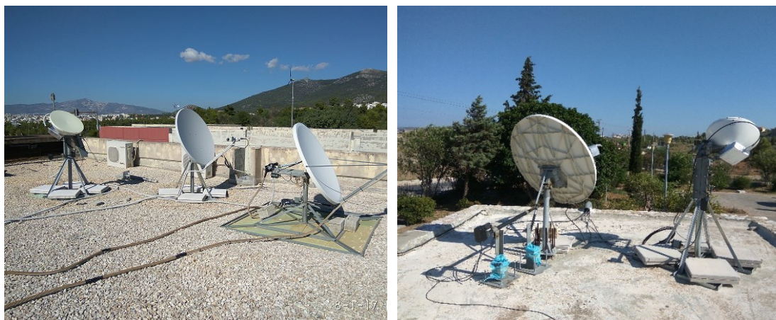
Σχήμα 1-3: Τα κεραιοσυστήματα των δεκτών στην Πολυτεχνειούπολη (αριστερά) και στο Λαύριο (δεξιά)
