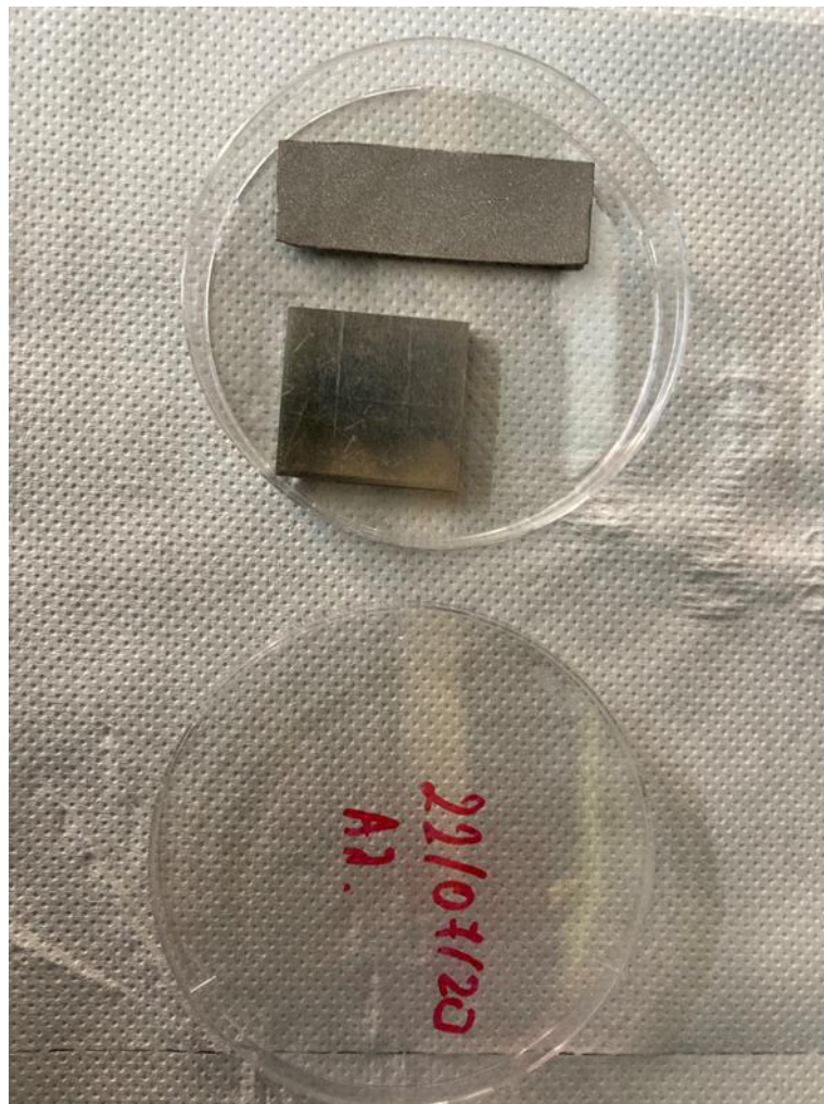
Εικόνα 19: Μεταλλικά δοκίμια AA-2024 (KA5) και Sanpac 4541 (KA6).
