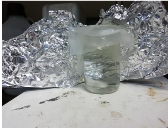
Εικόνα 20: Διάστημα αναγωγής t=1h από την προσθήκη νιτρικού αργύρου.
