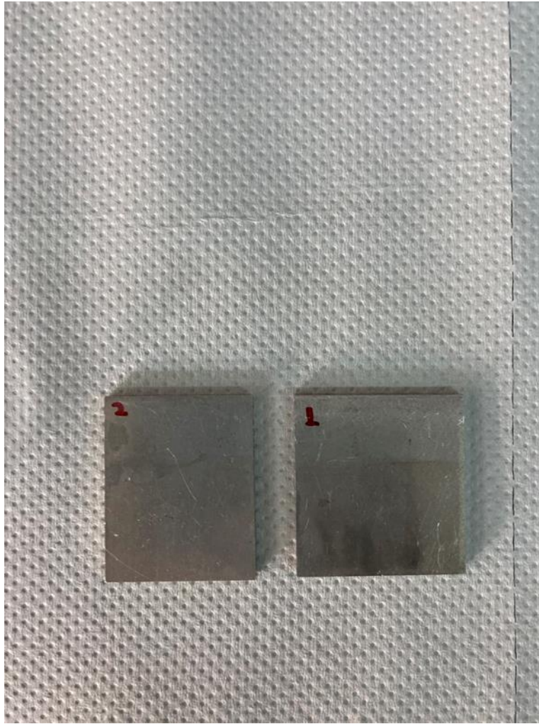
Εικόνα 18: Μεταλλικά δοκίμια AA-2024 για διάστημα παραμονής 3 λεπτών (KA3) δεξιά και 10 λεπτών (KA4) αριστερά.
