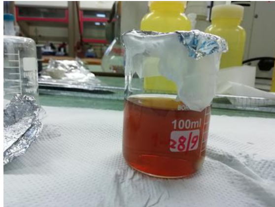
Εικόνα 27: Διάστημα αναγωγής t=72h από την προσθήκη νιτρικού αργύρου.
