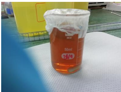
Εικόνα 25: Διάστημα αναγωγής t=24h από την προσθήκη νιτρικού αργύρου.
