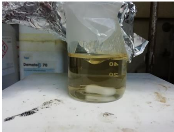
Εικόνα 21: Διάστημα αναγωγής t=2h από την προσθήκη νιτρικού αργύρου.
