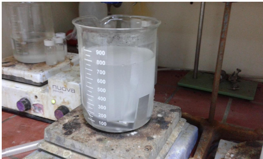
Εικόνα 16: Τοποθέτηση μεταλλικών δοκιμών σε αλκαλικό διάλυμα TURCO TM 4215. [24]
