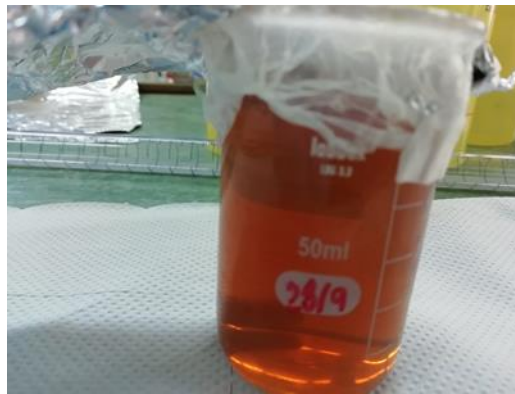
Εικόνα 28: Διάστημα αναγωγής t=96h από την προσθήκη νιτρικού αργύρου.
