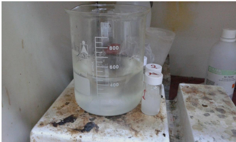
Εικόνα 17: Τοποθέτηση μεταλλικών δοκιμίων σε διάλυμα νιτρικού. [24]
