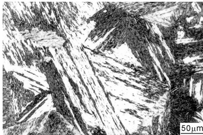
Εικόνα 35: Χαρακτηριστική μορφολογία πλακοειδούς μαρτενσίτη σε χάλυβα Fe – 0,2C [126].
