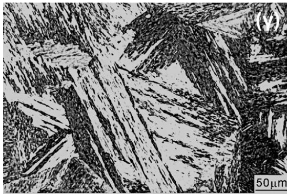
Εικόνα 28: Ενδεικτικές μορφολογίες μαρτενσίτη από εξέταση σε οπτικό μικροσκόπιο (α) βελονοειδής μαρτενσίτης (plate) κράματος Fe – 31Ni – 0.23C, (β) φακοειδής (lenticular) μαρτενσίτης κράματος Fe – 29Ni – 0.26C, (γ) πλακοειδής μαρτενσίτης κράματος Fe – 0.2C [126].
