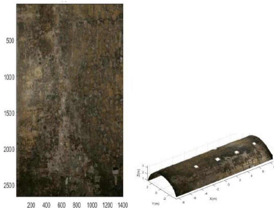
Εικόνα 2-11: Ανάπτυγμα κυλινδρικής επιφάνειας
