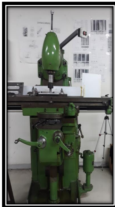
Εικόνα 29, Μηχανή F.S.W. (Σχολή Μηχανολόγων Μηχανικών).
