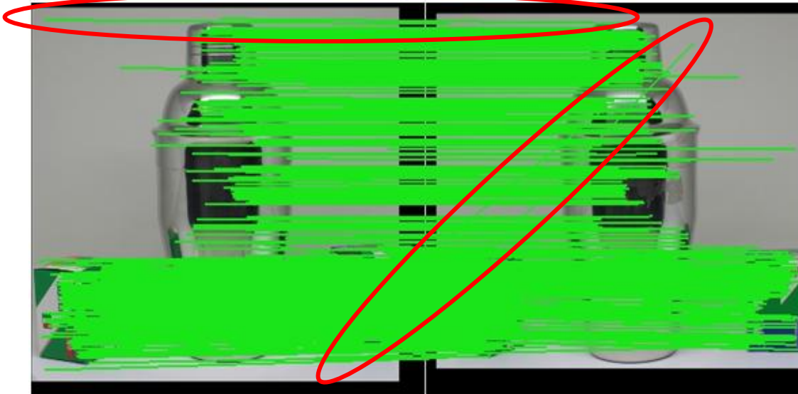
Εικόνα 11: Παράδειγμα ομολογιών πριν την εφαρμογή του RANSAC
