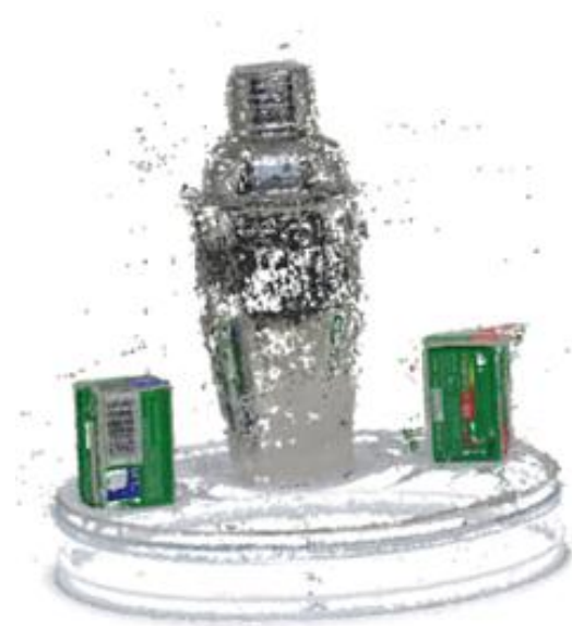
Εικόνα 58: Πυκνό νέφος σημείων (dense point cloud) του μεταλλικού σέικερ (shaker) στο πρώτο σετ φωτογραφίσεων με τα δυο αντικείμενα με υφή
