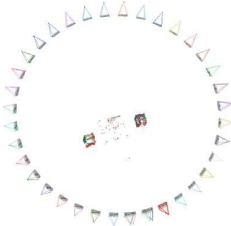
Εικόνα 69: Παράδειγμα απεικόνισης αραιού νέφους σημείων (sparse point cloud) σε περιβάλλον VisualSFM
