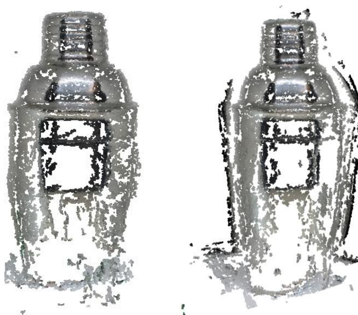
Εικόνα 92: Αποτέλεσμα πυκνού νέφους σημείων του μεταλλικού σέικερ (shaker) και στα δυο σετ φωτογράφισης μετά από εφαρμογή του κώδικα σε περιβάλλον του VisualSFM
