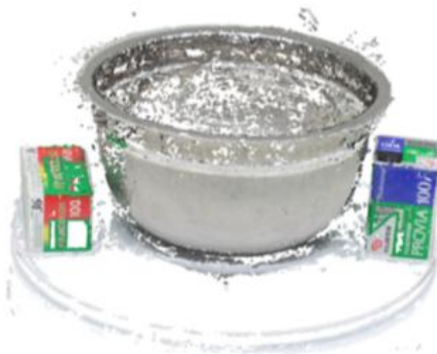
Εικόνα 54: Πυκνό νέφος σημείων (dense reconstruction) του μεταλλικού μπολ στο πρώτο σετ φωτογραφίσεων με τα δυο αντικείμενα με υφή
