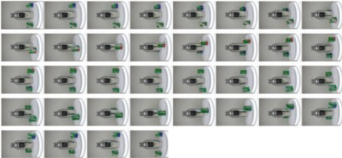
Εικόνα 31: Φωτογράφιση ανά 10 μοίρες του μεταλλικού σέικερ (shaker) μαζί με τα 2 κουτιά του φιλμ
