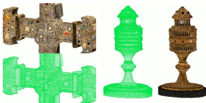
Εικόνα 6: Η υφή που έχει αποδοθεί βασισμένη στην διορθωμένη έκθεση πολωμένου φως (corrected polarised light exposition). Με πράσινο χρώμα είναι η 3Δ τριγωνική επιφάνεια (mesh)
