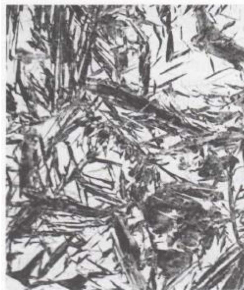
Εικόνα 13: Μικροφωτογραφία της μικροδομής φακοειδούς μαρτενσίτη . Οι βελονοειδείς κόκκοι είναι η φάση του μαρτενσίτη ενώ η λευκές περιοχές είναι υπολειπόμενος ωστενίτης που δε μετασχηματίσθηκε κατά τη ταχεία ψύξη (x1220). (Photomicrograph courtesy of United States Steel Corporation.)
