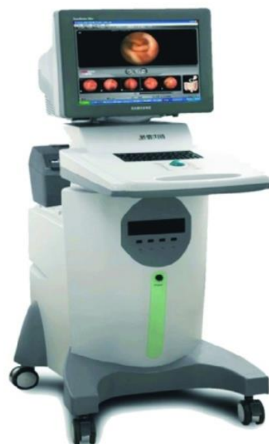
Εικόνα 1.10: (α) Δέκτης λήψης με 8 απαγωγές για τον εντοπισμό της θέσης της κάψουλας. (β) Μονάδα επεξεργασίας δεδομένων.
