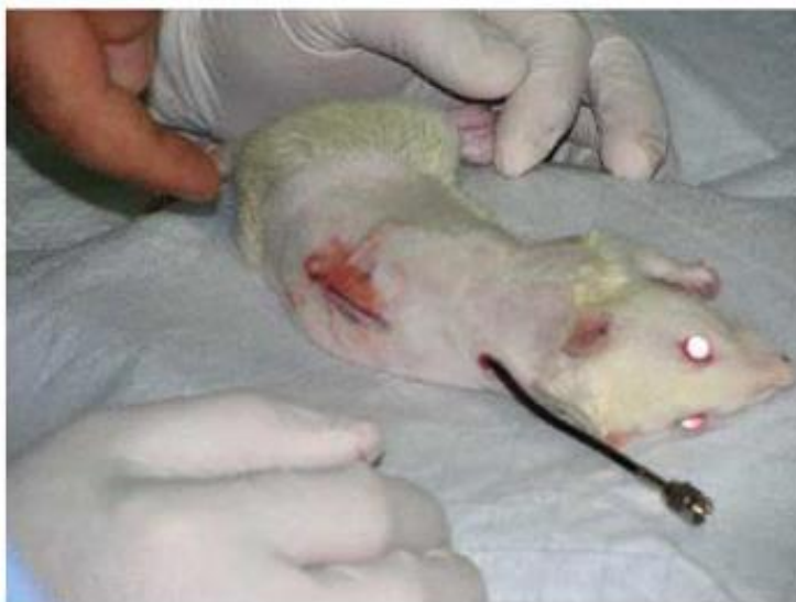
Εικόνα 2.11: Δοκιμή εμφυτεύσιμης κεραίας εντός ιστού ζώου. Η κεραία έχει εμφυτευτεί χειρουργικά στο ποντίκι.
