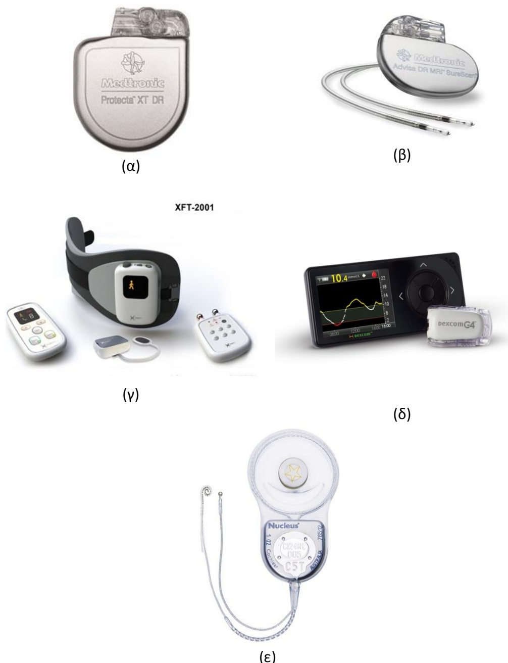
Εικόνα 1.8: (α) Βηματοδότης της Medtronic. (β) Καρδιακός απινιδωτής της Medtronic. (γ) Σύστημα νευρομυϊκής διέγερσης του κάτω άκρου. (δ) Συσκευή παρακολούθησης γλυκόζης της Dexcom. (ε) Κοχλιακό εμφύτευμα της Nucleus .
