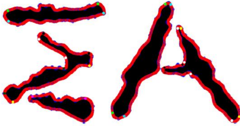
Εικόνα 18: Απεικονίζονται δύο πραγματοποιήσεις των γραμμάτων ‘Α’ και ‘Σ’. Τα κόκκινα τετράγωνα αναπαριστούν την πολυωνυμική προσέγγιση του περιγράμματος ενώ τα σημεία που απεικονίζονται με το ίδιο χρώμα (π.χ. πράσινο, μπλε, κτλ.) ορίζουν την αντίστοιχη πλευρά κάθε ξεχωριστού χτυπήματος. Τα σημεία καμπής απεικονίζονται με τελείες του ίδιου χρώματος.
