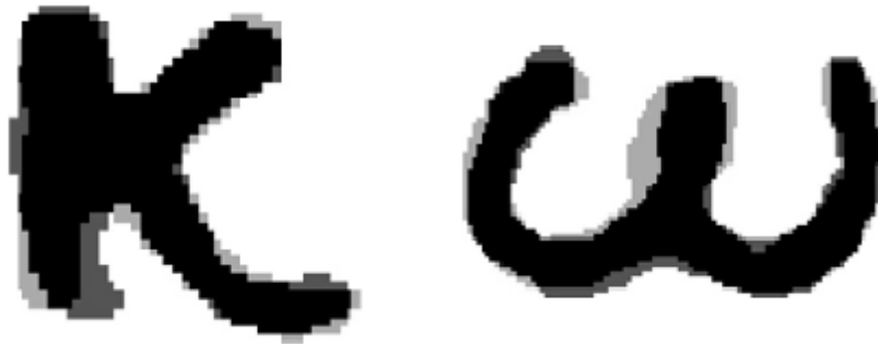
Εικόνα 27: Απεικονίζονται παραπάνω δύο βέλτιστα ταιριάσματα σύμφωνα με το κριτήριο 3.16 για τα γράμματα 'Κ' και 'Ω'. Το βέλτιστο ταιρίασμα λαμβάνεται με εύρεση του σημείου που μεγιστοποιεί το κριτήριο τομής διά ένωση γύρω από μία αρχική θέση ταιριάσματος που προσφέρεται από τα αποτελέσματα της πρότασης της ενότητας 3.5. Πρέπει να σημειωθεί ότι και οι δύο πραγματοποιήσεις κάθε γράμματος έχουν γραφτεί από τον ίδιο γραφέα, πράγμα που έρχεται σε συμφωνία με τα συμπεράσματα της παρουσιαζόμενης μεθόδου.
