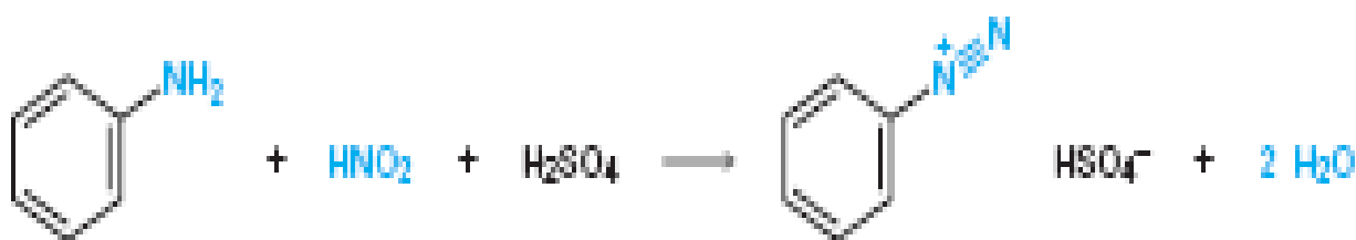
Εικόνα 5: Αντίδραση διαζώτωσης της φαινυλαμίνης
