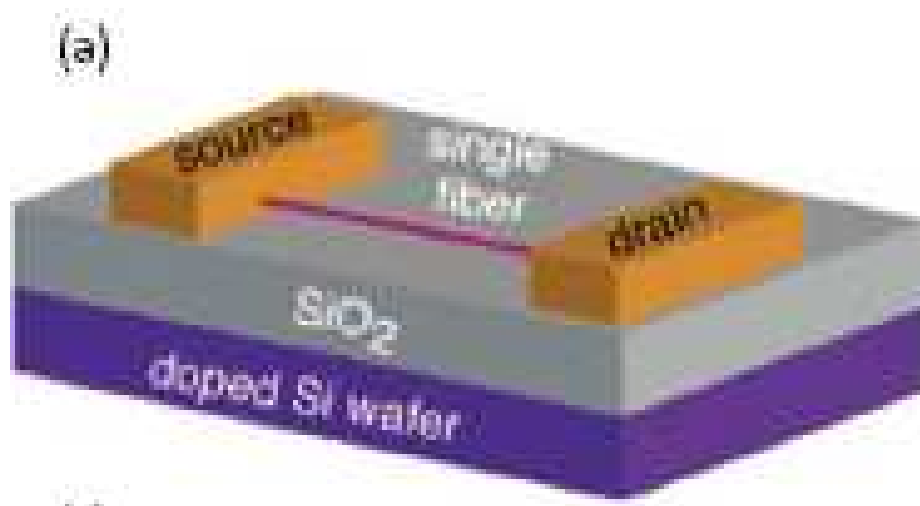
Εικόνα 22: Σχηματική δομή νανο-μετασχηματιστή HTP
