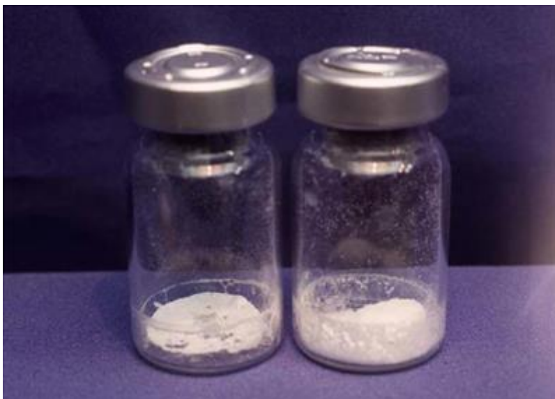
Σχήμα 16. Κατάρρευση σε προϊόν. Υπερέβηκε η κρίσιμη θερμοκρασία. Πηγή [35]
