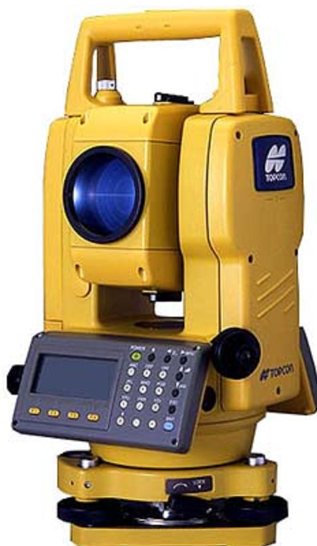
Εικόνα 4. 1: Γεωδαιτικός Σταθμός « TOPCON GPT 3003»
