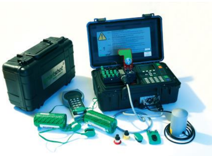
Εικόνα 10: Σύστημα πυροδότησης της ανατίναξης
