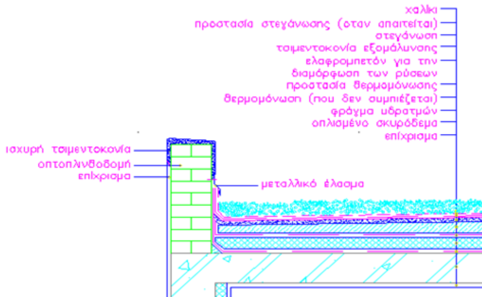
Σχήμα 2.23: Λεπτομέρεια δώματος.
