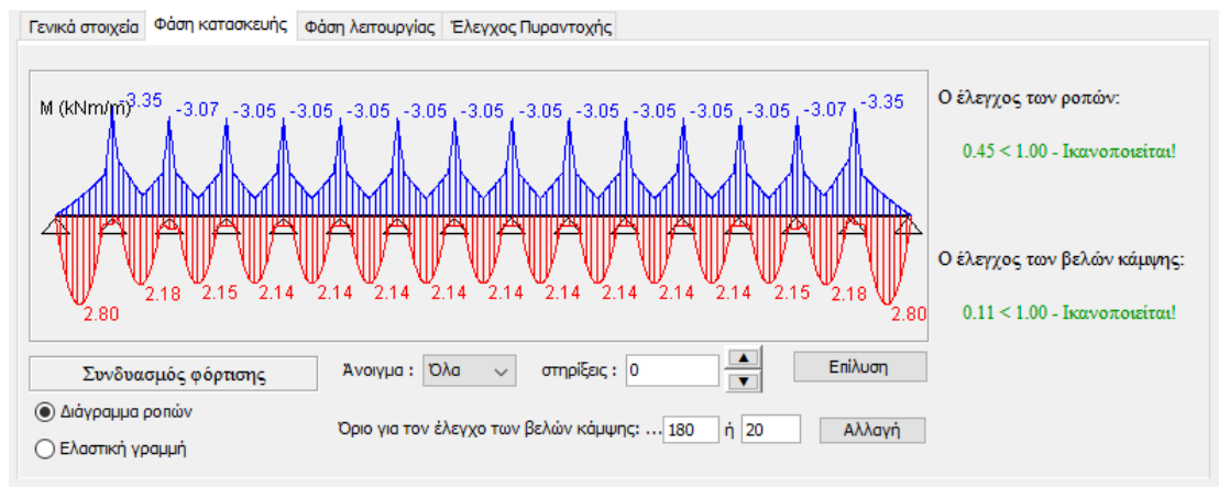
Σχήμα 5.8: Φάση κατασκευής – Περιβάλλουσα ροπών.
