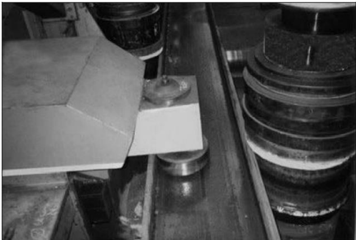
Σχήμα 2.5 : Καμπύλωση ανοιχτής διατομής στην οποία φαίνονται τα επιπλέον κύλινδρα για την αποτροπή λυγισμού του κορμού.
