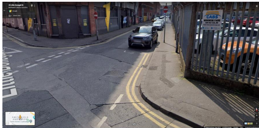
Εικόνα 3.42: Παράδειγμα σύνδεσης πεζοδρομίων με ύπαρξη μίας ράμπας όπου C1\_2=1 , Μπέλφαστ (πηγή: Google Street View)
