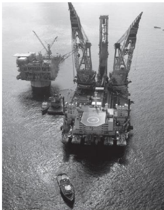
Εικόνα 2.3: Σκάφος μεθόδου S-lay (Palmer et al.,2008)
