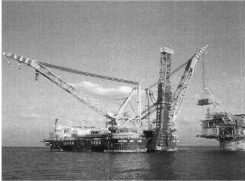
Εικόνα 2.6: Σκάφος Saipem S7000 με πύργο J-lay (Guo et al.,2014)
