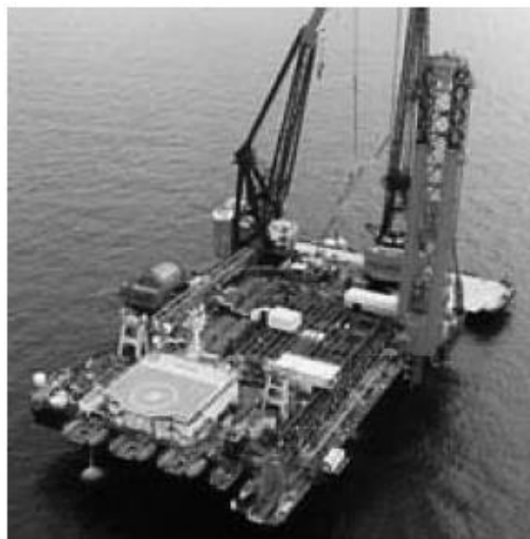
Εικόνα 2.5: Σκάφος Heerema's Balder με πύργο J-lay (Guo et al.,2014)
