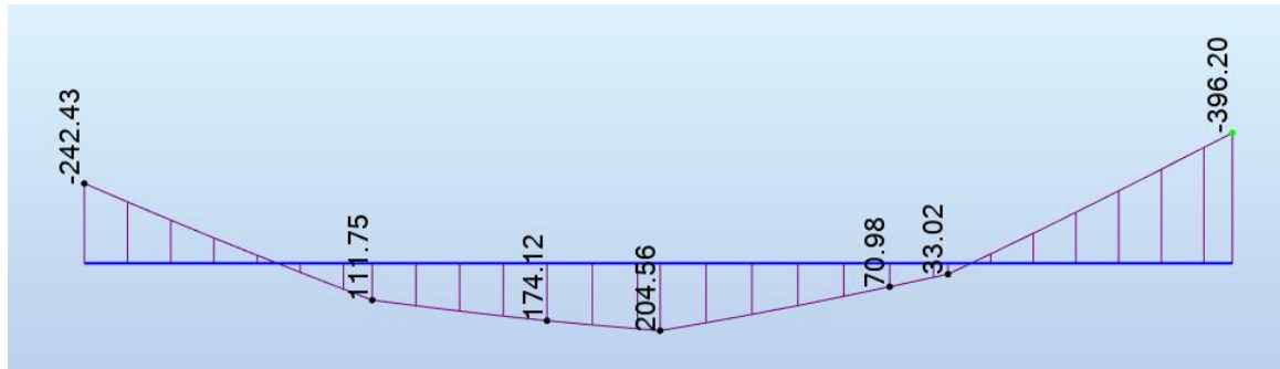
Σχήμα 6.28: Διαγράμματα ροπών κάμψεως για το συνδυασμό 1.00G+0.60Q [kNm]
