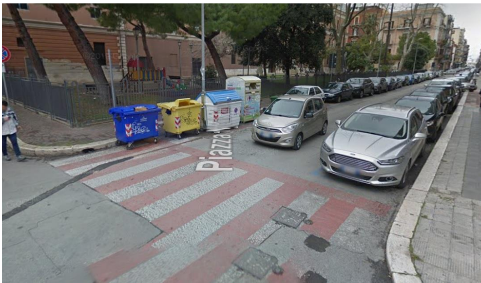
Εικόνα 3.30 Στο υπό εξέταση τμήμα δεν υπάρχουν ράμπες στα άκρα των πεζοδρομίων C1\_2=0 (Πηγή: Street View)
